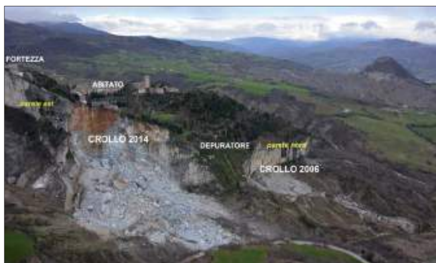
Figura 8. Foto panoramica scattata da elicottero dopo il crollo 2014 nello spigolo NE della rupe visibile in primo piano. Il crollo ha generato un'estesa e potente coltre di detrito che ha invaso gran parte della valle del fosso Campone. Sulla destra, sempre lungo il lato nord della rupe, si apprezza il crollo del 2006 con una lunga lingua di detrito che si sviluppa ai piedi della parete per colamento successivo al crollo
