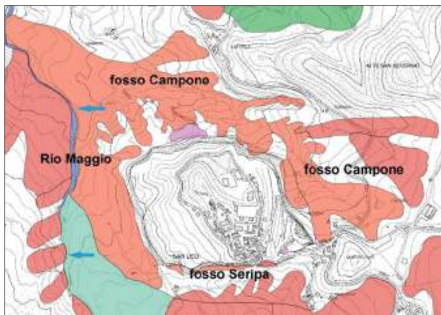
Figura 6. Stralcio della Carta dell'inventario del dissesto della Regione Emilia-Romagna (aggiornamento 2012) in cui si apprezzano le frane attive (in rosso) nelle argilliti che circondano la placca rocciosa di San Leo. I fossi Campone e Seripa che si sviluppano ai piedi della rupe e confluiscono nel Rio Maggio, incidono le argilliti. Particolarmente articolata è la situazione lungo il fosso Campone dove diversi rami confluiscono in un corpo di frana principale che insiste sul Rio Maggio
