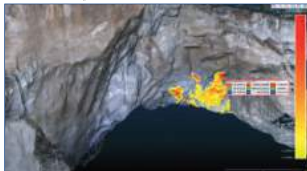
Figura 14. Quantificazione delle distanze di scostamento positivo tra la nuvola di punti determinata nel dicembre del 2016 e la nuvola di punti determinata nella primavera del 2014.
