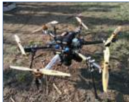
Figura 3. Drone multirottore ESAPLY 2500 di SAL Engineering (Modena) equipaggiato con camera fotografica Canon EOS 600D.
