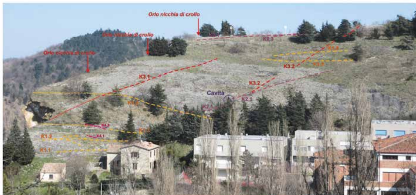
Fig. 12 - Traccia delle principali fratture sulla sommità della rupe (famiglie K1, K2, K3 e K4).
