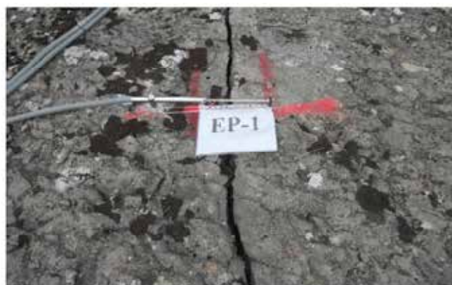
Fig. 25 - Estensimetro a barra. L'estensimetro a barra misura l'apertura della frattura con una precisione minore o uguale a 0,5 mm. È più affidabile e preciso dell'estensimetro a filo.
