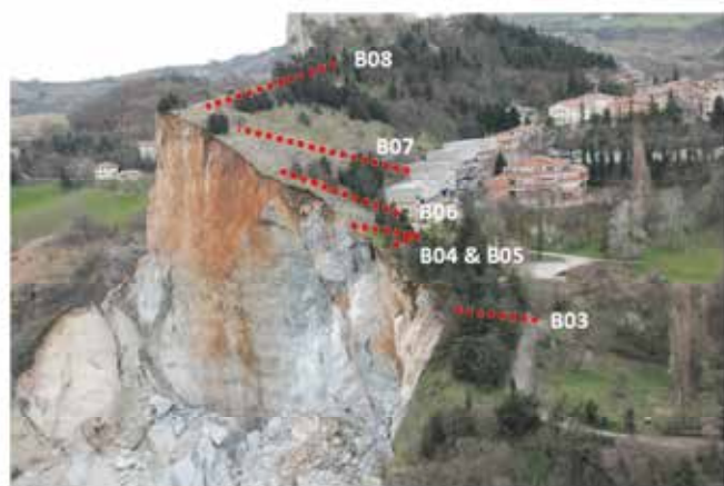
Fig. 33 - Traccia dei fori attrezzati con gli estensimetri multibase per il monitoraggio delle fratture profonde.
