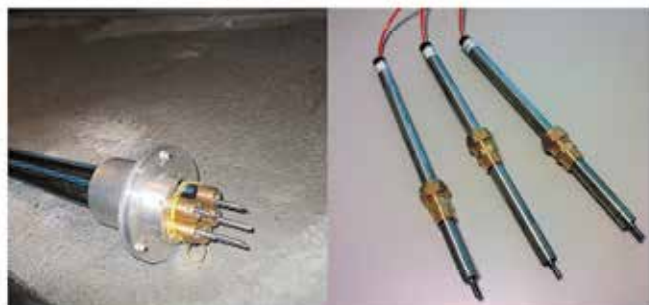
Fig. 28 - Testa di estensimetro multibase (a sinistra) e relativi trasduttori o potenziometri. Gli estensimetri in foro possono essere costituiti da una (estensimetro monobase) o più basi di misura (estensimetro multibase) ancorate mediante cementazione a quote prestabilite all'interno di una perforazione. I punti di ancoraggio sono collegati alla superficie con aste in acciaio opportunamente protette da guaine anti-attrito che favoriscono lo scorrimento. Il movimento delle aste rispetto alla testa di riferimento installata in superficie permette di determinare i movimenti dell'ammasso o della struttura monitorata attraverso la misura del loro spostamento.
