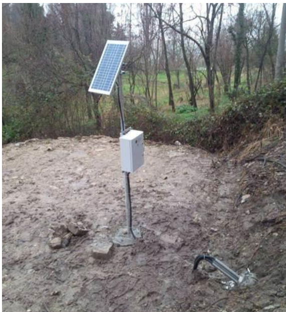
Fig. 19 – Centralina di acquisizione e trasmissione dati in remoto con relativi sensori multibase in foro. A destra, dettaglio della testa di estensimetro multibase (a 3 basi).
