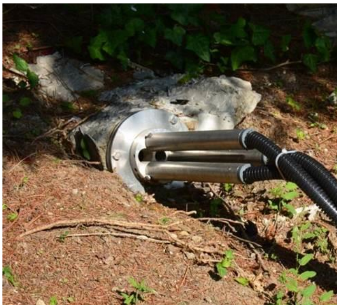
Fig. 19 – Centralina di acquisizione e trasmissione dati in remoto con relativi sensori multibase in foro. A destra, dettaglio della testa di estensimetro multibase (a 3 basi).
