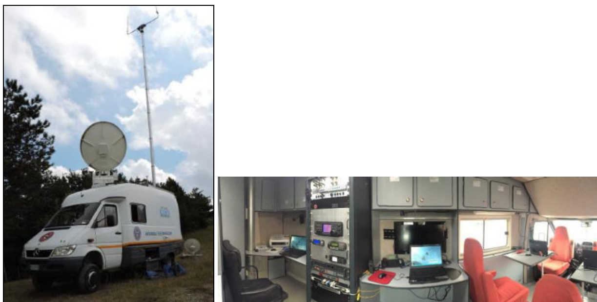
Figura 3-8 Camper per le telecomunicazioni in dotazione al Volontariato e suo allestimento interno.
