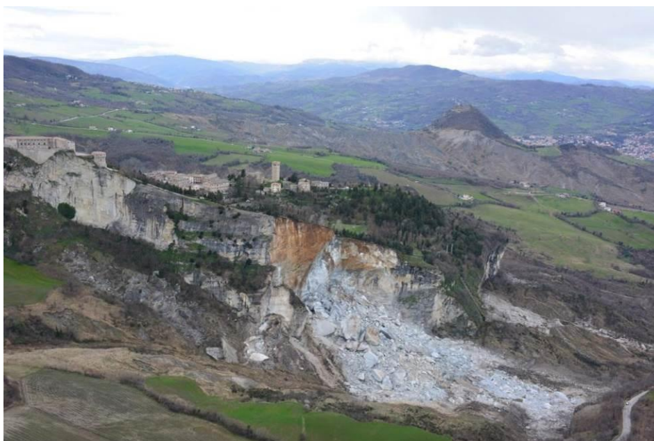
Figura 1- Foto panoramica da elicottero (vista da nord-est) che mostra la parete del crollo (febbraio 2014) e l'accumulo detritico sottostante in tutto il suo sviluppo in corrispondenza del versante nord della rupe. Il volume coinvolto nel crollo è pari a circa 330.000 mc.
