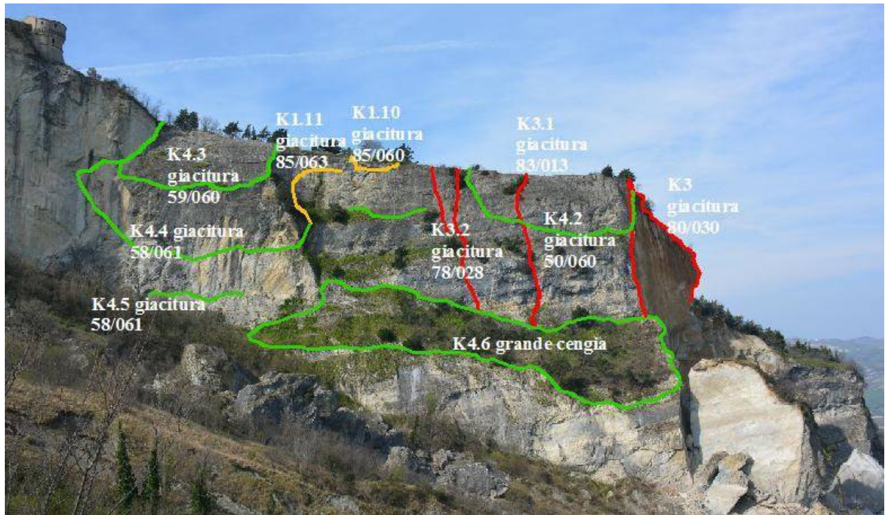
Figura 1 – Superfici di discontinuità individuate con le calate su corda sulla parete Est.
