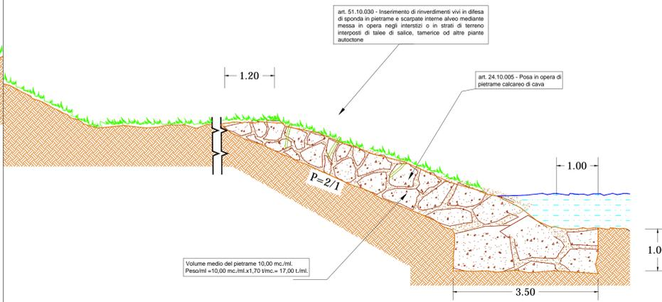
**SEZIONE TIPO: COPERTURA DIFFUSA IN SALICI CON FASCINATA scala 1:50**
